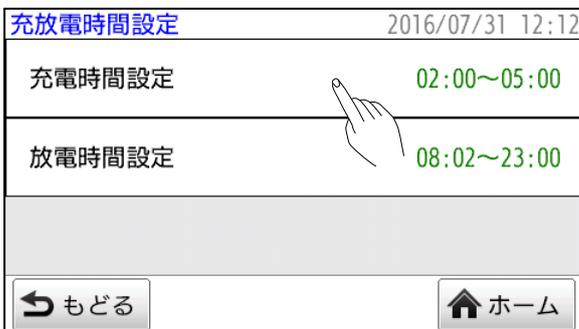
④充電時間と放電時間が表示されます。充電時間を変更する場合は「充電時間設定」の領域を、放電時間を変更する場合は「放電時間設定」領域を押します。
