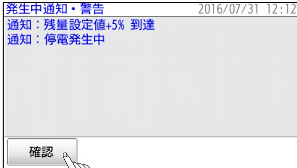
停電時において、放電により蓄電池の残量が“停電時放電停止残量設定+5%”になったときに表示されるメッセージです。
