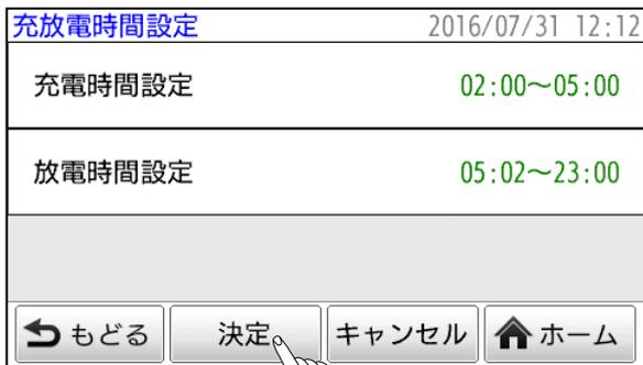
⑥ 「決定」ボタンを押してください。充電時間と放電時間が設定されます。「キャンセル」ボタンを押すと変更開始前の時間にもどります。
