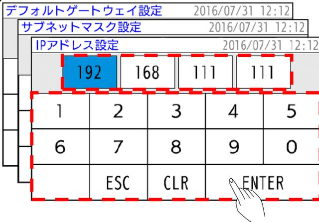
⑧ IP アドレスの変更したいオクテットをタッチし、テンキーでアドレスを設定してください。入力に誤りがあった場合には「CLR」ボタンを押して入力をやり直してください。入力が完了したら「ENTER」ボタンを押してください。変更を中止してもどるときは「ESC」ボタンを押してください。
