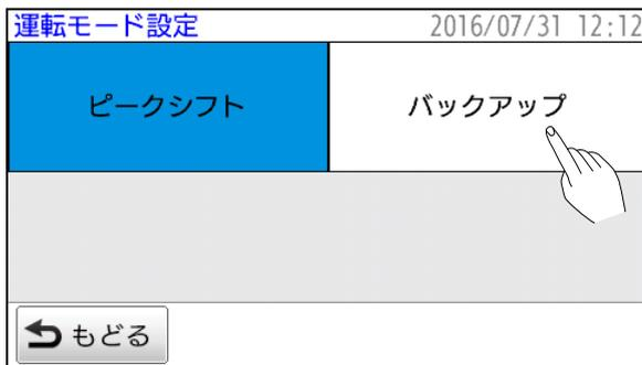
③設定されているモードの背景が青く表示されています。変更するモードの領域を押します。左図はピークシフトモードからバックアップモードに変更する例です。
