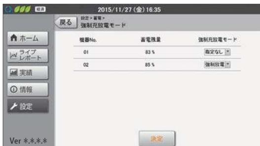
2セット目の太陽光発電用ハイブリッド蓄電システム（ア）を併設している場合、強制充放電モードの設定は個別で設定できます。
