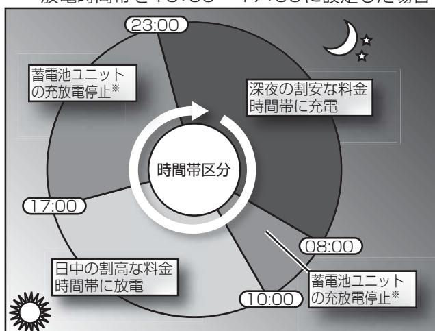
左記の例のように、深夜 / 日中 / 朝夕と 3 つの時間帯に分かれた電気料金プランの場合、深夜に充電時間帯を設定することにより、割安な料金で蓄電池に充電でき、また、日中に放電時間帯を設定することにより、割高な料金の時間帯には蓄電池ユニットから放電します。
