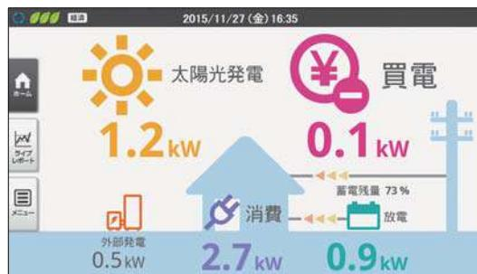
現在の発電電力や蓄電残量の数値などを簡単に確認できます。また、パワーコンディショナの運転状況（運転モード、抑制状態や異常の発生など）も確認できます。
