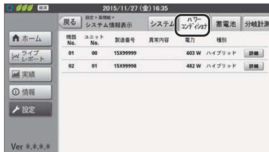
本システムと併設しているシステム（アとイ）のパワーコンディショナの情報も表示されます。
