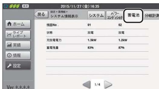
2セット目の太陽光発電用ハイブリッド蓄電システム（ア）を併設している場合、2台目の蓄電池ユニットの情報も表示されます。
