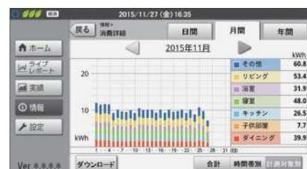
消費電力量を計測対象別に色分けして表示します。どこで電気が多く使用されているか確認することができます。
