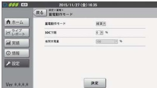
2セット目の太陽光発電用ハイブリッド蓄電システム（ア）を併設している場合、蓄電動作モードの設定は一括で設定されます。
