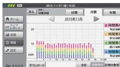
消費電力量を 4 つの時間帯別に色分けして表示します。時間帯で料金が異なる契約の場合に、節約の目安として利用できます。
