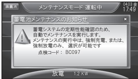
16 ページで設定されている充電時間帯に充電を行い、その後、設定している通常動作モードで、時間帯に関係なく、蓄電池から放電を行います。メンテナンスモード終了後は、通常モードに戻ります。
